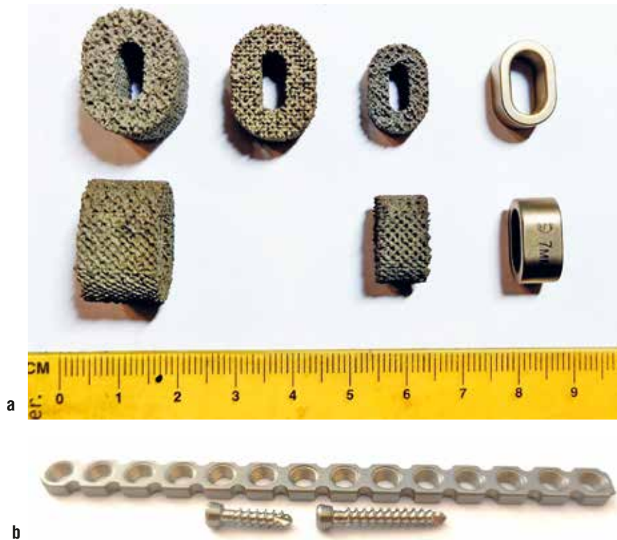
Рис. 3. Макрофото имплантов для хирургического лечения цервикальной спондилломиелопатии: а – доступные для использования кейджи, изготовленные серийно (7 мм) и методом 3D-печати (6, 8, 12 мм), б – используемые для фиксации тел позвонков реконструктивная LP пластина и губчатые блокируемые винты диаметром 3,5 мм Macrophoto. Implants for surgical treatment CSM: а – Interbody cage 7 mm and 3D-printing Interbody cage 6, 8, 12 mm, б – reconstructive LP plate and 3.5 mm sponge lockable screws
